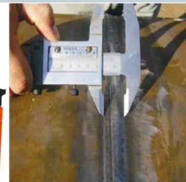
ЗАО «Трест СЗЭМ» успешно применяло установку автоматической орбитальной сварки «Протеус» производства отечественной компании ЗАО НПФ «ИТС» для сварки порошковой проволокой в среде защитных газов ( $Ar+CO_2$ ) неповоротных стыков циркуляционных трубопроводов на Нововоронежской АЭС-2 (диаметр 2400 мм, толщина стенки 17 мм, 09Г2С).
