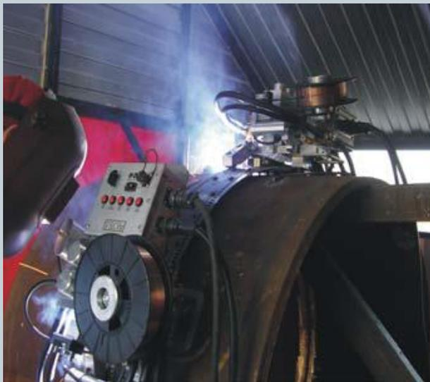
Схема установки головки «ПРОТЕУС» на трубу
